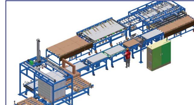
Hệ thống đóng gói tấm thạch cao Công ty CP CN Vĩnh Tường Packaging & Palletizing system (tiles, plasterboard) - VinhTuong JSC
